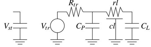
(b) Equivalent RC circuit.
