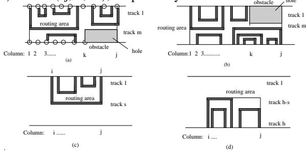
Figure 3: (a) A valid routing solution for  $T1(j,k,m)$ ; (b) a valid solution for  $T2(j,k,m)$ ; (c) A valid solution for  $I1(i,j,s)$ ; (d) a valid solution for  $I2(i,j,s)$ .
